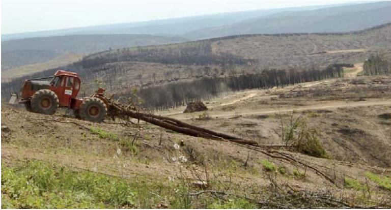
*Saca de madera con skider, lo que incrementa el riesgo de erosión por arrastre de troncos*
